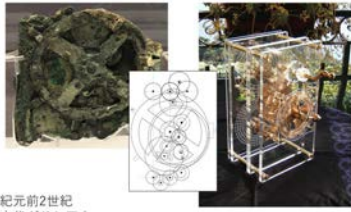
紀元前2世紀 古代ギリシア人 歯車式アナログコンピュータ(世界最古) アンティキティラ島の機械
